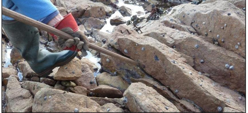
*Fig. 34 et 35 – Le débitage des dalles à la barre à mine est facilité par la fracturation du microgranite par des diaclases formant des parallélépipèdes (simulation).*
